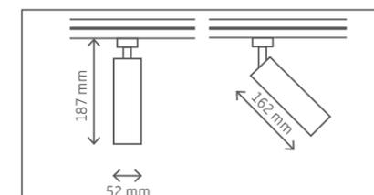
Bei der Montage sind unbedingt die Lichtprojekt Montagerichtlinien (Seite 80) einzuhalten. Technische Änderungen vorbehalten. Bitte beachten Sie, dass der Strahler auf die richtige Phase eingestellt ist. Der Strahler wird Phasen-/abschnitt-dimmbar ausgeliefert, auf Anfrage ist er auch DALI oder 1-10V dimmbar (mit seitlichem Gehäuse) lieferbar.
