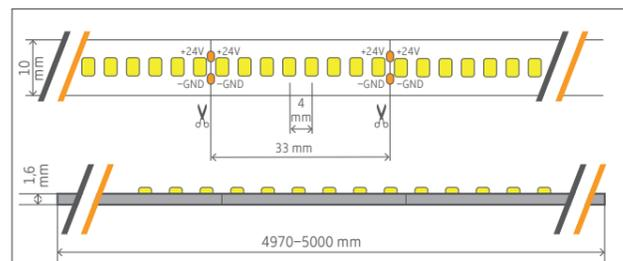
Bei der Montage sind unbedingt die Lichtprojekt Montagerichtlinien einzuhalten (Seite 80). Der Strip muss alle 5m neu eingespeist und auf einem Alukühlkörper (Profil) montiert werden. Die Strips sind ausschließlich für Indoor-Anwendungen geeignet. Der Lichtstrom und die Farbwiedergabe können aufgrund von Fertigungsprozessen von Charge zu Charge variieren. Technische Änderungen vorbehalten. Konfektionierung auf das gewünschte Maß möglich.
